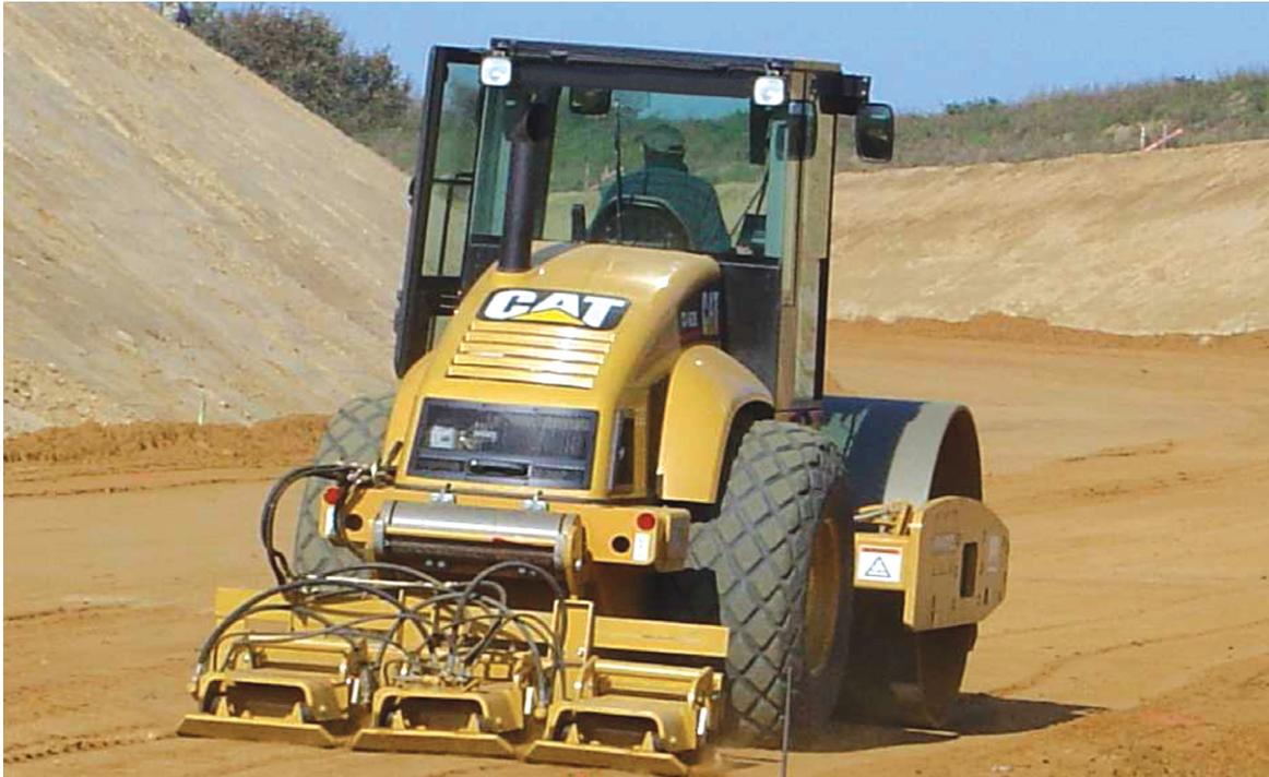
**Placas vibratorias posteriores** – En material no cohesivo, los compactadores vibratorios de suelo de un solo tambor pueden ser equipados con placas vibratorias posteriores, lo que proporciona un sellado de la superficie que no se puede lograr con solamente el compactador de un solo tambor. Esto permite al operador considerar el gradiente de compactación: el rodillo vibratorio de un solo tambor logra una compactación profunda y la placa vibratoria compacta y sella la superficie.
